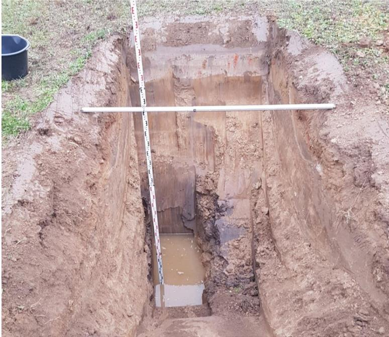
Foto 3: Schurf S1, Durchführung des Versickerungsversuchs, aufgenommen am 19.11.2020
