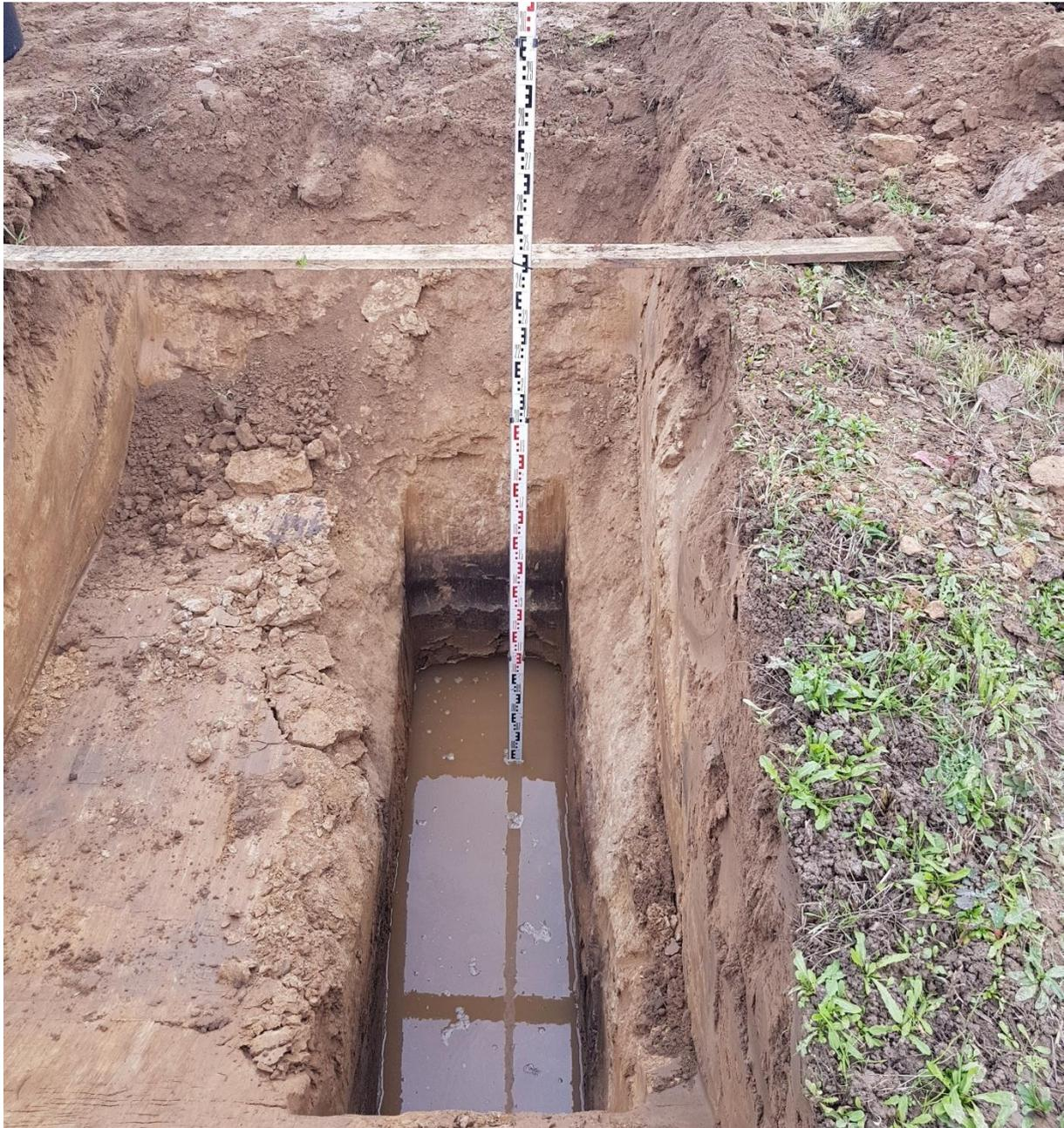
Foto 5: Schurf S3, Durchführung des Versickerungsversuchs, aufgenommen am 19.11.2020
