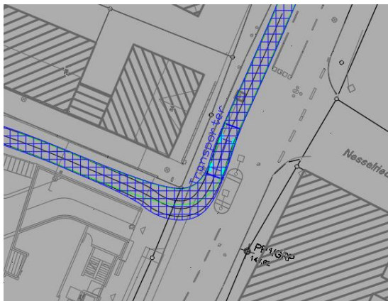
Abbildung 2: Prüfung Schleppkurven Transporter durch RS Ingenieure, Dezember 2020 (links: Einfahrt aus Norden)
